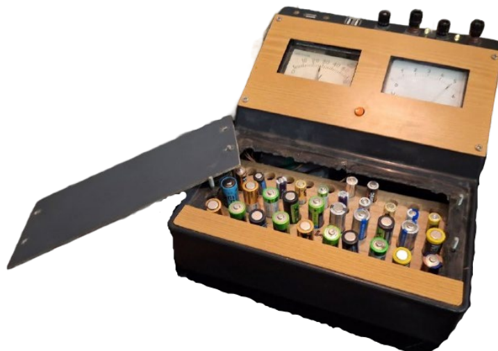
Рис. 2. Действующий макет установки по извлечению остаточной электроэнергии
