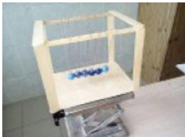
Рис. 1. Прибор для демонстрации закона сохранения импульса
