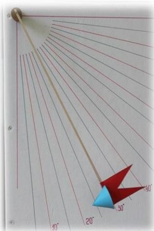
Рис. 4. Шкала прибора для демонстрации сопротивления воздуха
