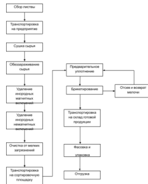
Рисунок 1. Этапы производства брикетов.
