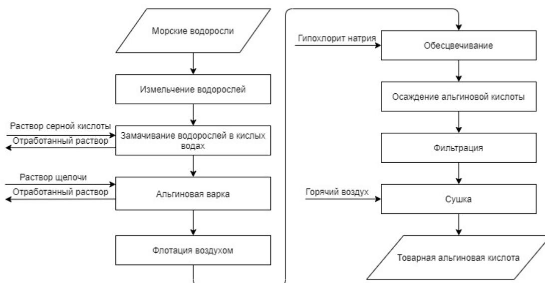
Рис. 2. Схема производства альгиновой кислоты
