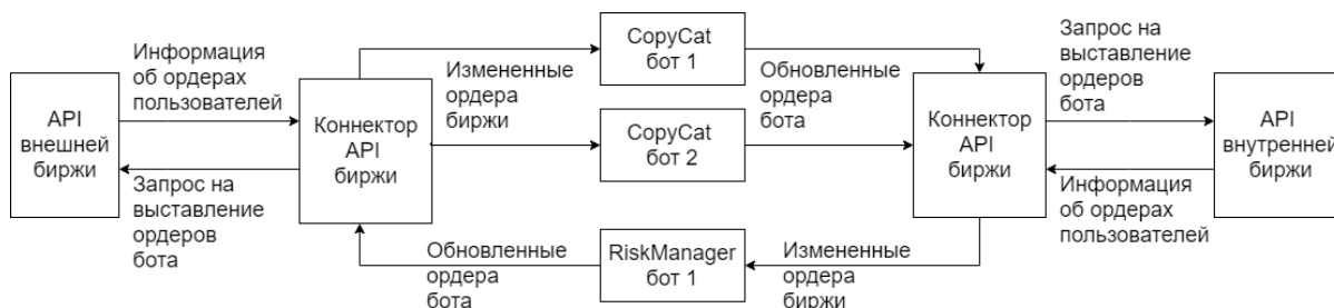
Рис. 2. Подключение ботов к биржам и получение информации/совершение действий в модели CopyCat с резервированием
