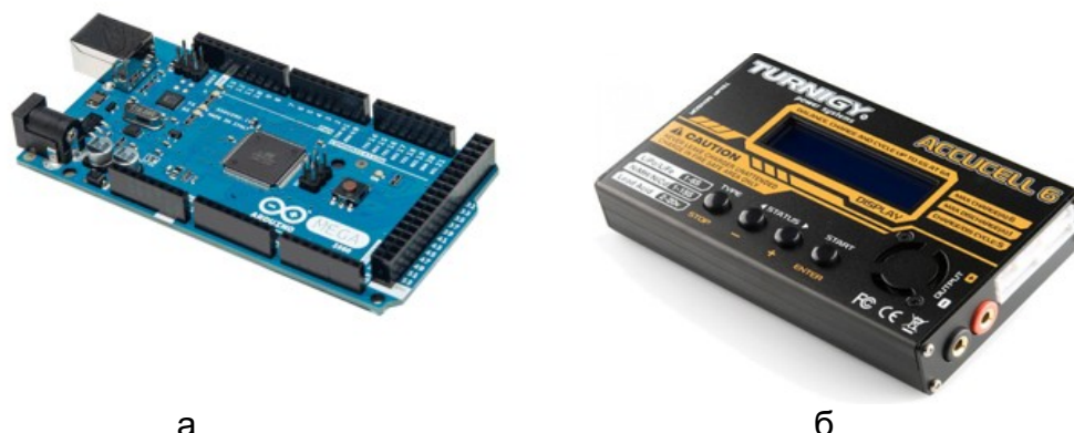
Рис. 1. Используемый компоненты: а) Контроллер Arduino Mega; б) Зарядное устройство Turnigy Accucell 6
