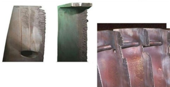
Рис. 2. Характерный вид эрозийных повреждений лопаток паровых турбин
