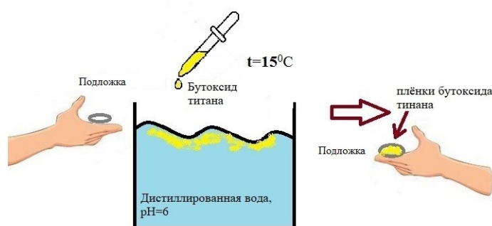
Рис. 1. Формирование пленок бутаоксида титана на диэлектрической подложке с помощью модифицированного метода Ленгмюра-Блоджетт
