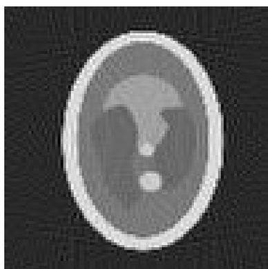
Рис. 6. Изображение, восстановленное алгоритмом свертки и обратной проекции с предварительной фильтрацией.
