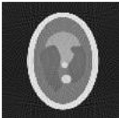
Рис. 7. Изображение, восстановленное алгоритмом свертки и обратной проекции с регуляризацией Тихонова
