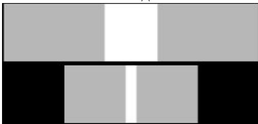
Рис. 5. Компьютерное моделирование эффективности оптического контакта двух одномодовых оптических волокон: а) без коллимирующей и фокусирующей линзы, б) с коллимирующей и фокусирующей линзы. Примечание: метод плоских доменов показывает более низкую границу величин эффективности, которая в действительности может быть выше
