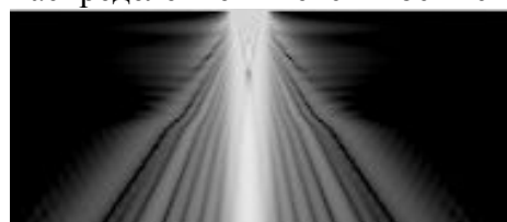
Рис. 3. Свет появляется из верхнего конца оптоволоконной коллимирующей эллиптической линзы диаметром 124 \mu и фокальной длиной 88 \mu ( \lambda = 1 \mu ) и проходит вниз до подобной фокусирующей линзы, установленной на конце противоположного оптического волокна. Промежуток между линзами – 4 \mu
