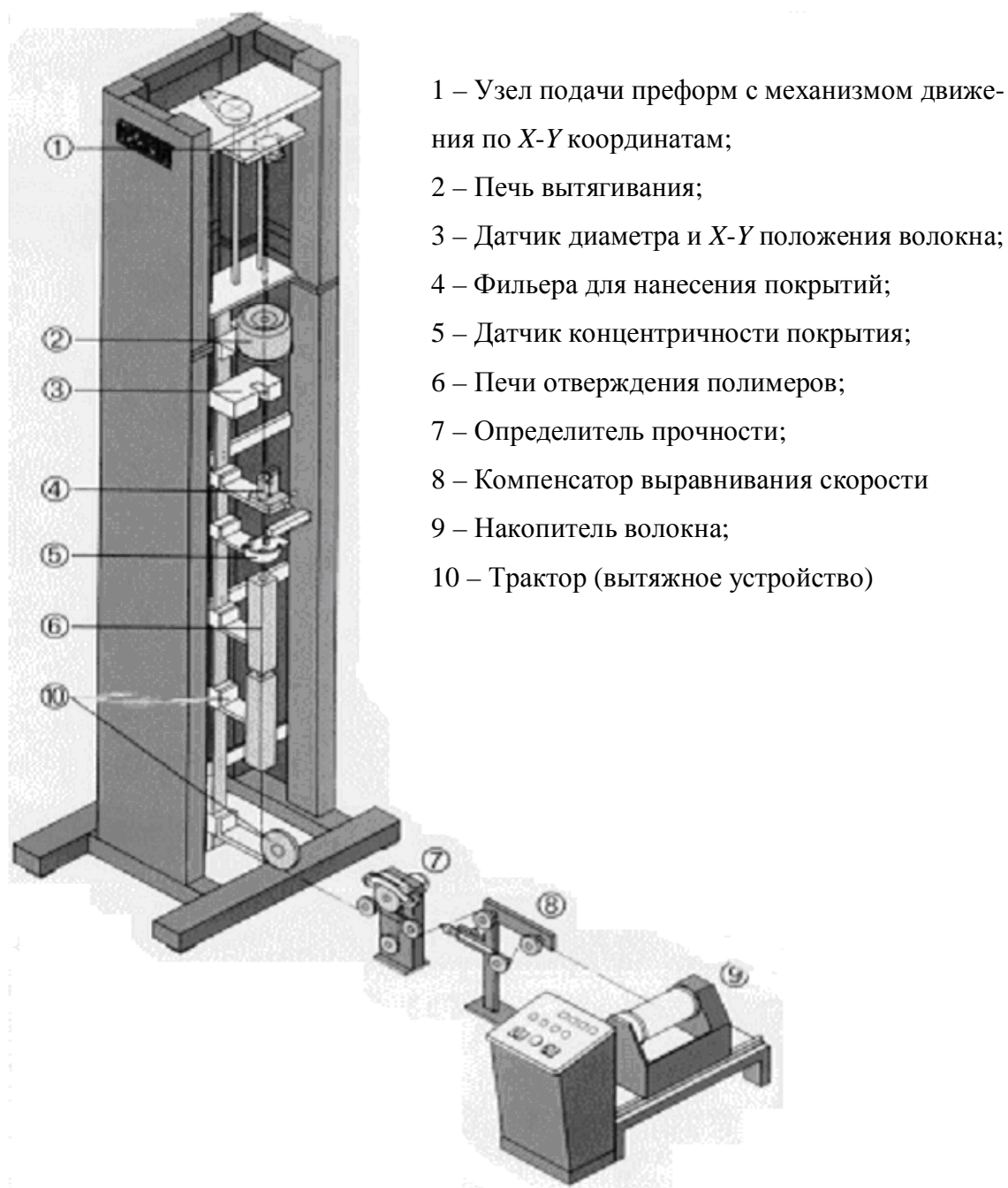
Рис. 2 Схема башни для вытягивания оптического волокна
