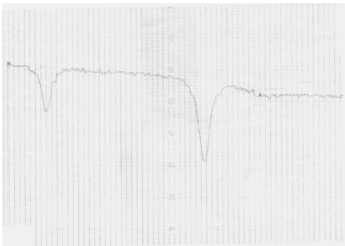
Рис. 2. Характерный вид спектральной характеристики пропускания ( f_{упр}=2,27 МГц, \lambda_1=1550 нм – слева, \lambda_2=1630 нм – справа)
