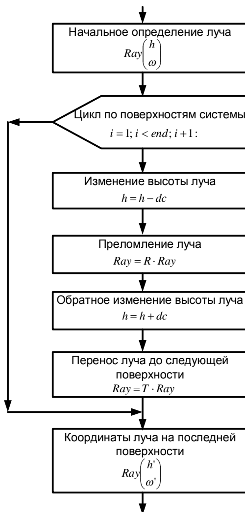
Рис. 1.2. Алгоритм расчета хода параксиального луча через децентрированную оптическую систему
