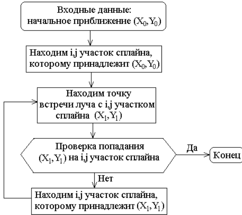
Рис. 1. Блок-схема уточнения точки встречи луча со сплайн-функцией с начальным приближением
