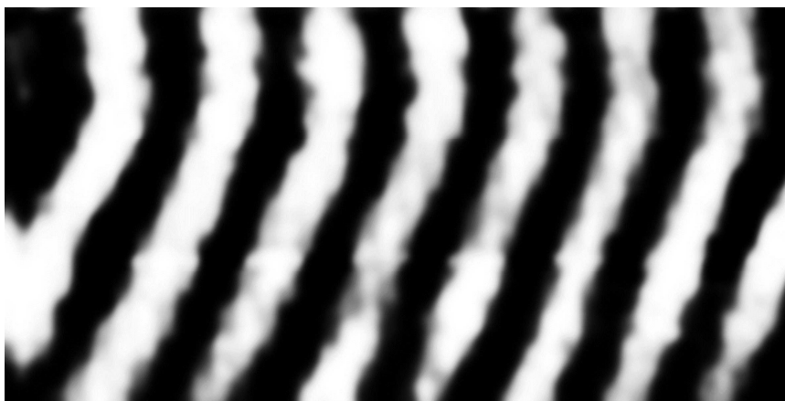
Рис. 3. Смещение максимумов интерференционных полос вследствие дрейфа сканатора
