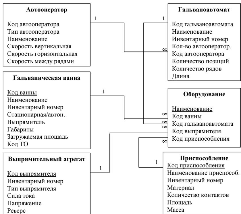
Рис. 2. Модель базы данных «Проектирование» САПР ТП гальванического производства
