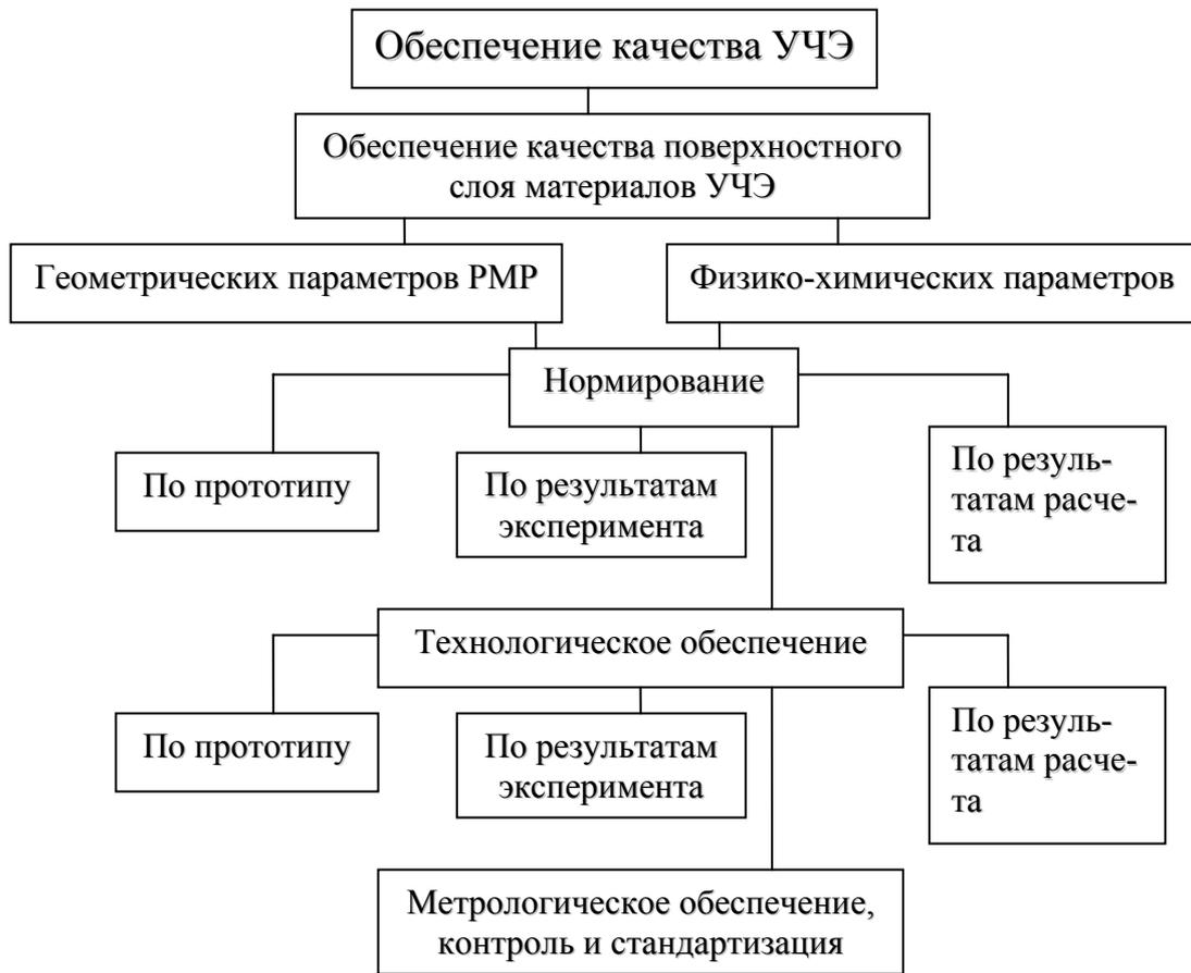
Рис. 2. Проблема качества рабочей поверхности УЧЭ
