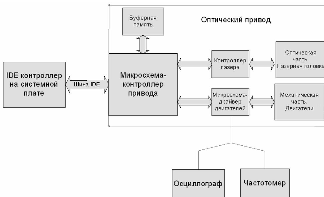
Рис. 4. Блок-схема установки для исследования пишущих приводов
