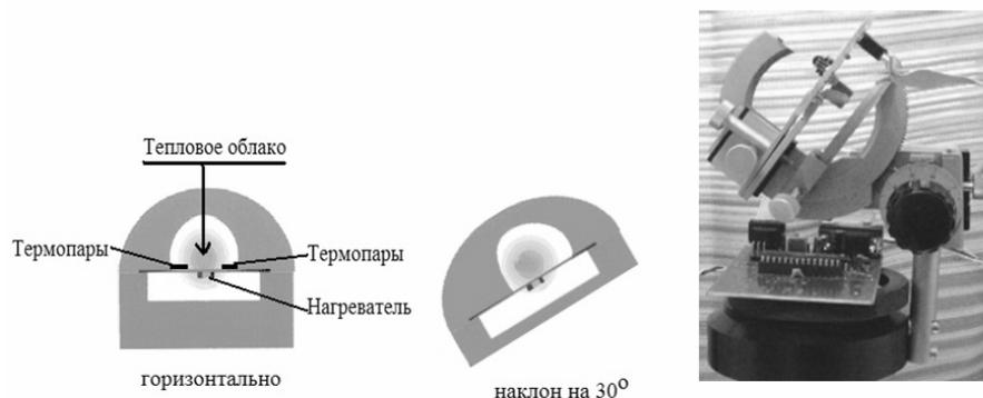
Рис. 5. Схема работы угломера и тестовая установка
