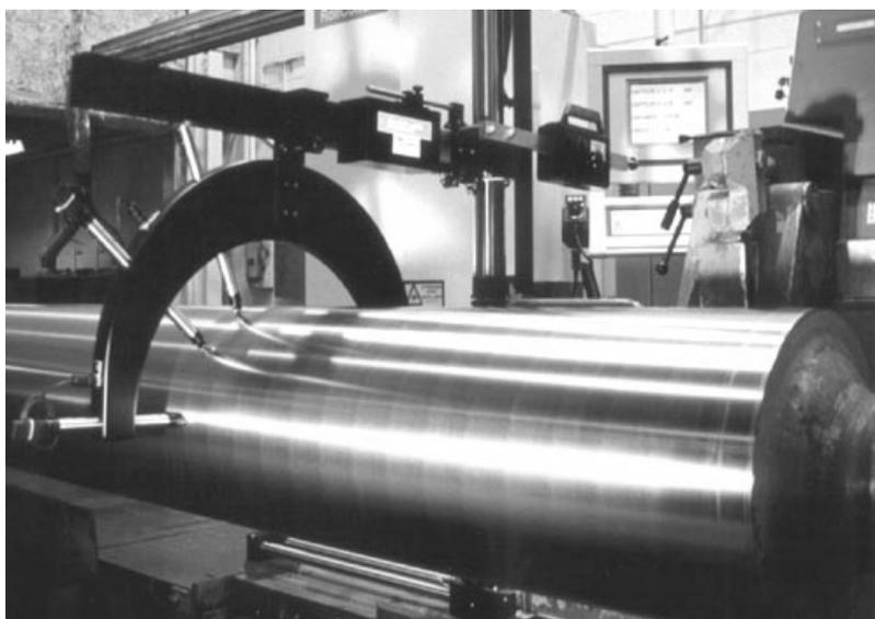
Рис. 5. Измерительная система RollCal-2
