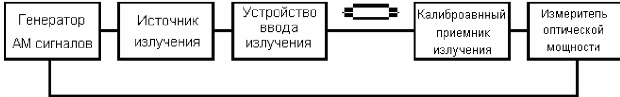
Рис. 6. Измерение полосы пропускания частотным методом
