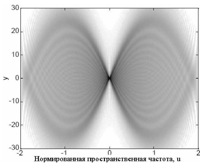
Рис. 5. Зависимость МПФ от дефокусировки системы формирования изображения с кубической фазовой пластинкой
