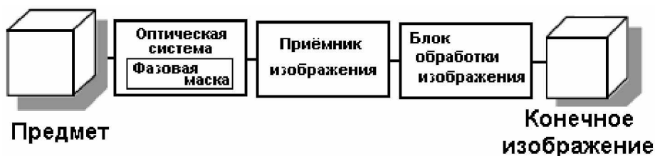
Рис. 1. Обобщенная блок-схема оптико-цифровой системы с кодированным волновым фронтом
