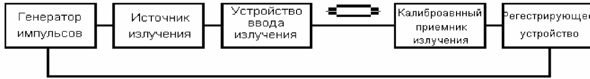
Рис. 5. Измерение полосы пропускания импульсным методом
