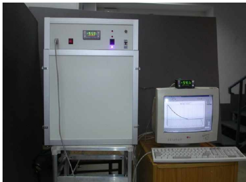
Рис. 4. Термоэлектрическая термокамера для воспроизведения климатических условий Крайнего Севера (объем 4 л, температура минус 70\text{ C} )
