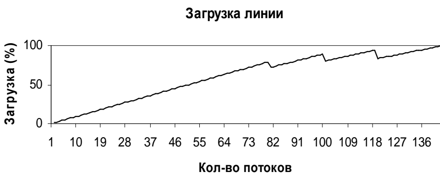
Рис. 4. Увеличение числа потоков за счет применения сжатия
