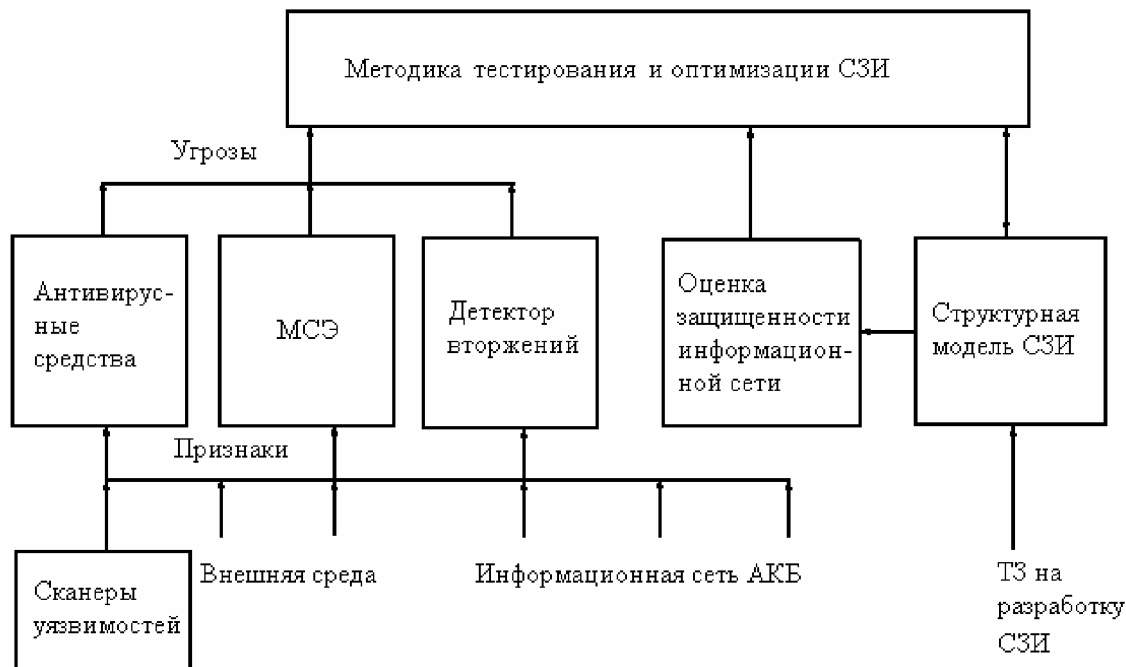
Рис. 1. Система защиты информации информационной сети АКБ
