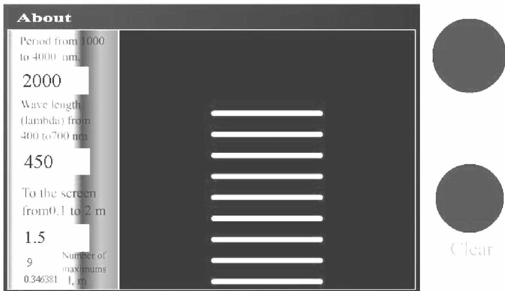
Рис. 2. Исследование дифракции на решетке
