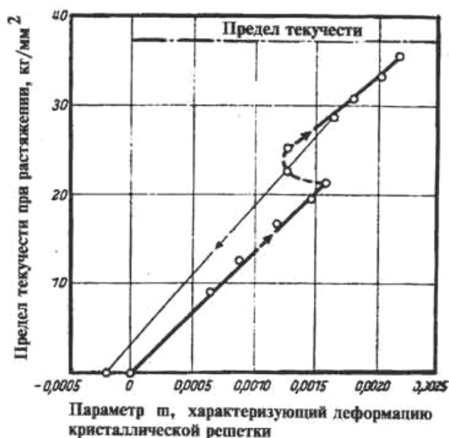
Рис. 3. Изменение параметра m^* с ростом напряжения в образце из углеродистой стали с 0,61 %C
