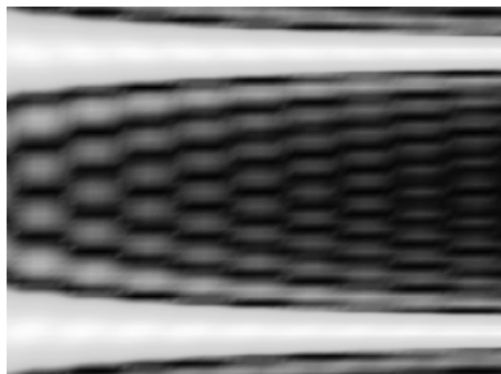
Рис. 5. Дифракционная картина, содержащая муаровые полосы, от апертуры с параметрами a = 0.05 мм, \theta = 7 \times 10^{-3} рад., z = 180 мм
