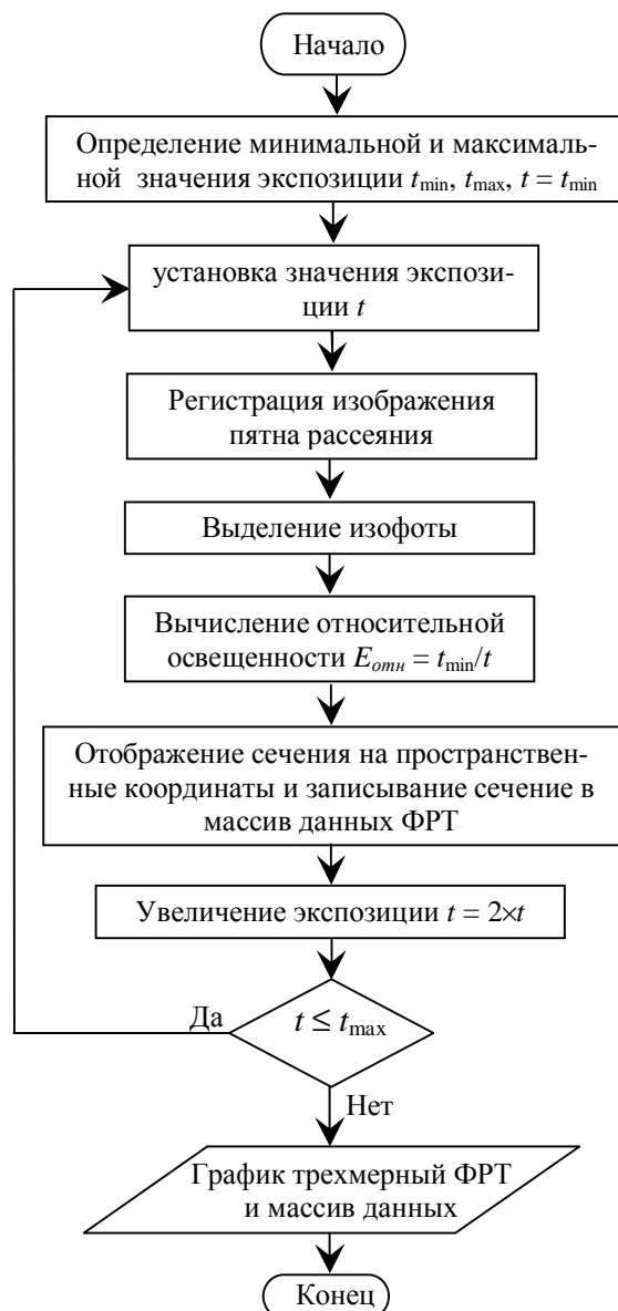
Рис. 3. Алгоритмическое решение компьютерной версии изофотометрии с переменным накоплением
