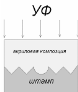
Рис. 3. Заполнение гибкого штампа жидкой акриловой композицией и ее полимеризация УФ-излучением
