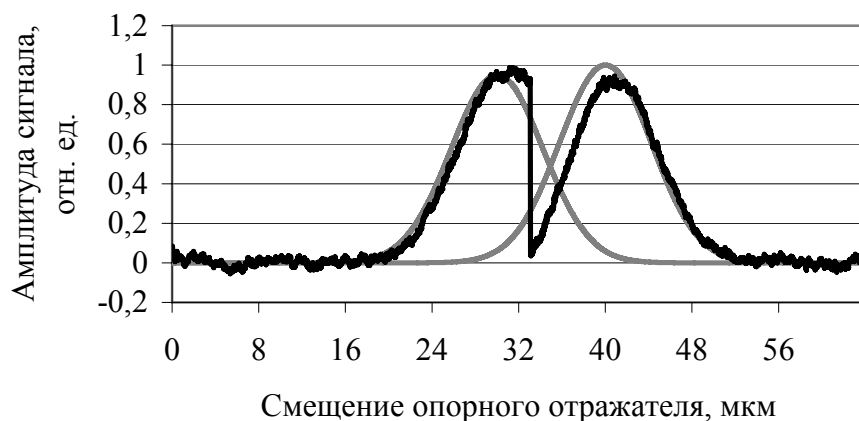
Рис. 4. Оценка огибающей интерференционного сигнала с двумя максимумами
