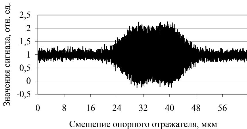
Рис. 3. Зашумленный сигнал с двумя максимумами
