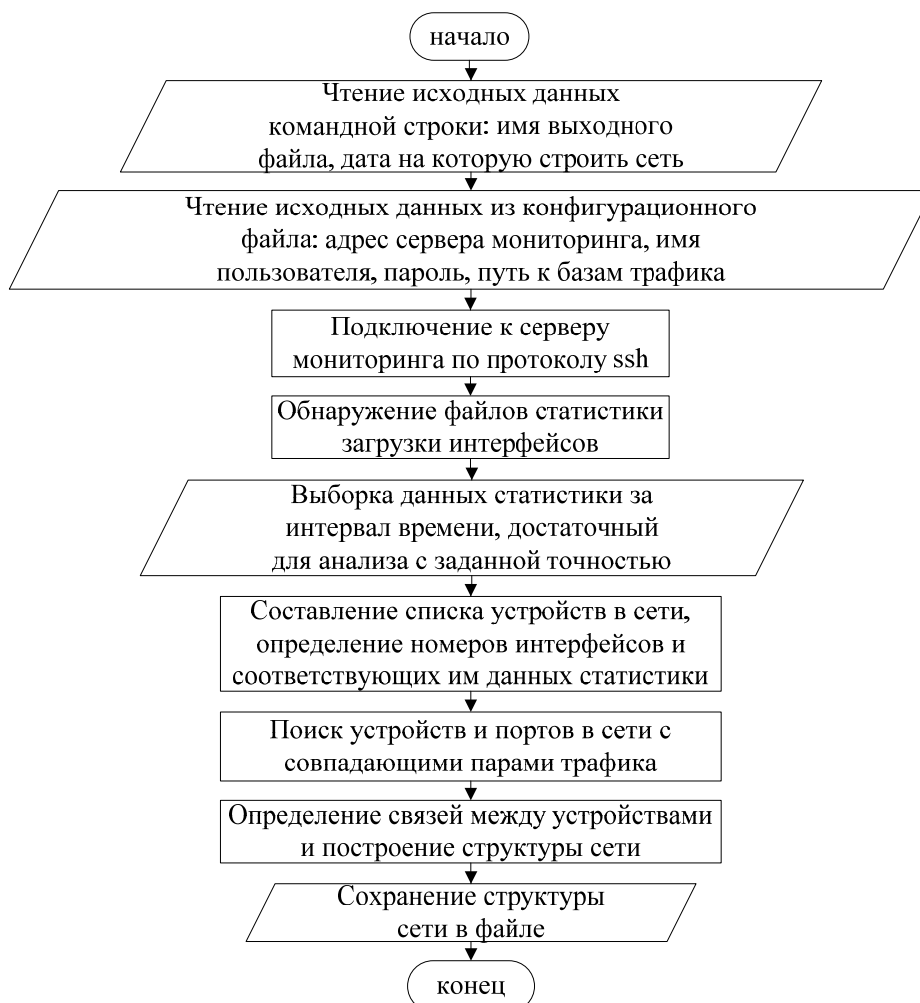
Рис. 3. Блок-схема алгоритма динамического построения структуры сети
