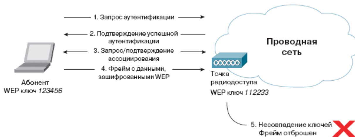
Рис. 2. Открытая аутентификация с несовпадающими WEP-ключами
