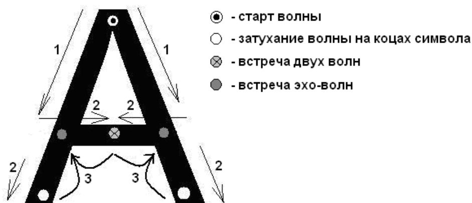
Рис. 3. Направление распространения волны вдоль символа «А» с фиксированием позиций концов символов и петель, а также распространение эхо с фиксированием позиции пересечений (1, 2, 3 – шаги распространения волны и эхо)
