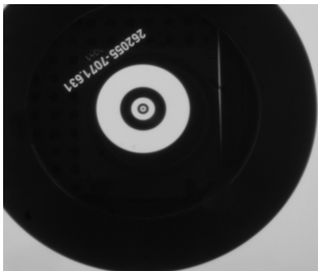
Рис. 5. Калибровочный шаблон в проходящем свете
