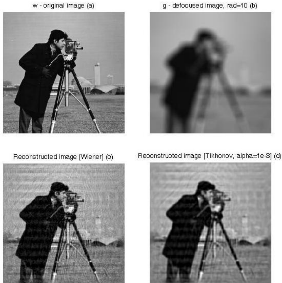
Рис. 4. Результат реконструкции дефокусированного изображения: а) исходное изображение; б) дефокусированное изображение, \rho = 10 ; с) метод Винера ( \sigma_{\text{отн}} = 0,25 ); д) метод ПФ и РТ, \alpha = 10^{-3} ( \sigma_{\text{отн}} = 0,22 )
