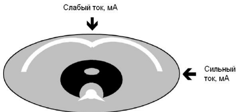
Рис. 3. Изменение силы тока рентгеновской трубки как функции от угла поворота I(\theta)
