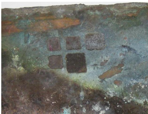
Рис. 4. Фрагмент выколотной медной скульптуры в процессе очистки (небольшие участки очищены излучением импульсного Nd:YAG лазера)
