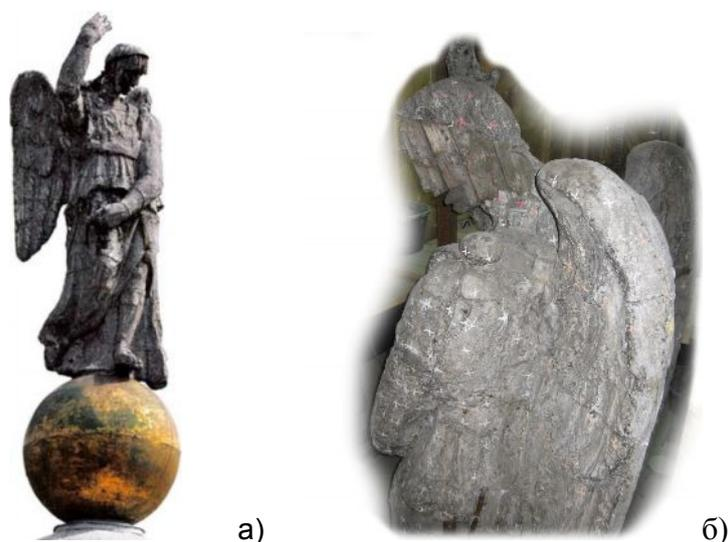
Рис. 3. а) Статуя свинцового ангела до реставрации; б) Фрагмент ангела после снятия с купола
