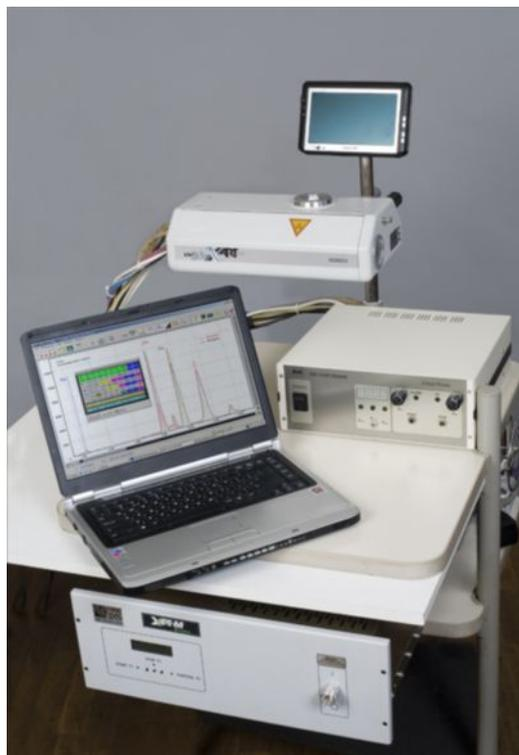
Рис. 1. Рентген-флуоресцентный анализатор X-Арт М (общий вид)
