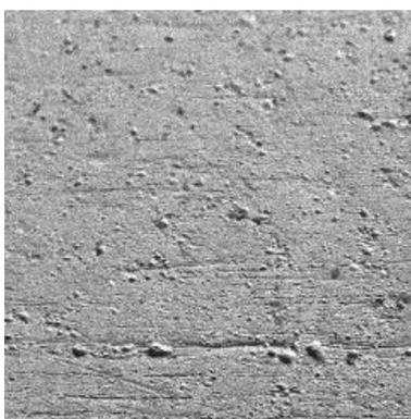
Рис. 2. Изображение поверхности образца после обработки CO<sub>2</sub> лазером (плотность мощности  $32 \times 10^4$  Вт/см<sup>2</sup>), полученное на электронном сканирующем микроскопе
