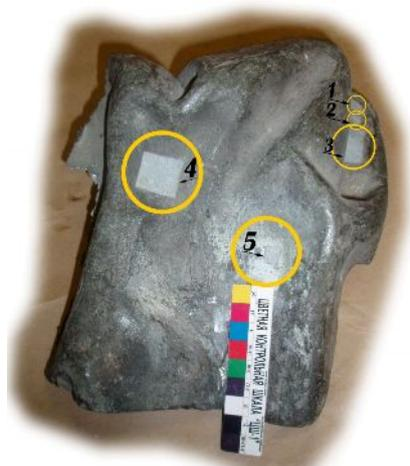
Рис. 2. Фрагмент цинковой статуи Рубенса, в процессе лазерной очистки при различных значениях уровня плотности энергии 1)  $9,5 \text{ Дж/см}^2$ ; 2)  $13 \text{ Дж/см}^2$ ; 3)  $16 \text{ Дж/см}^2$
