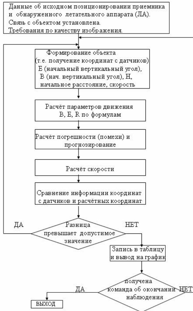
Рис. 1. Алгоритм определения параметров движения ЛА
