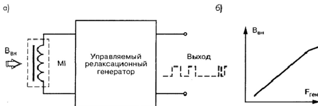
Рис. 2. Магнитоиндуктивный датчик: а) упрощенная схема включения; б) – выходная характеристика
