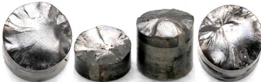
Рис. 2. Разрушенные штемпеля
