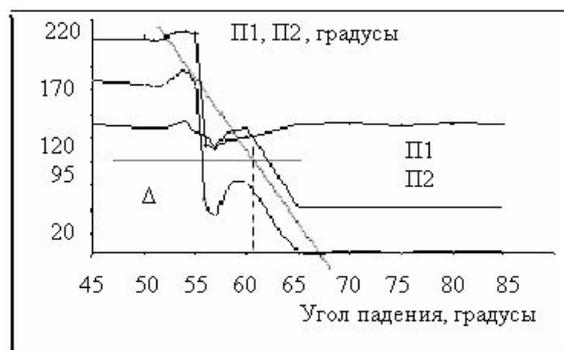
Рис. 5. Азимуты анализатора и поляризатора для ОИ №1 и его фазовой функции ( $\Delta$ ) от углов падения
