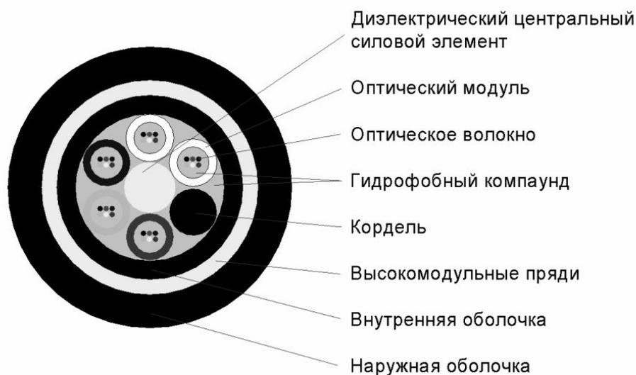
Рис. 2. Схема конструкции кабеля
