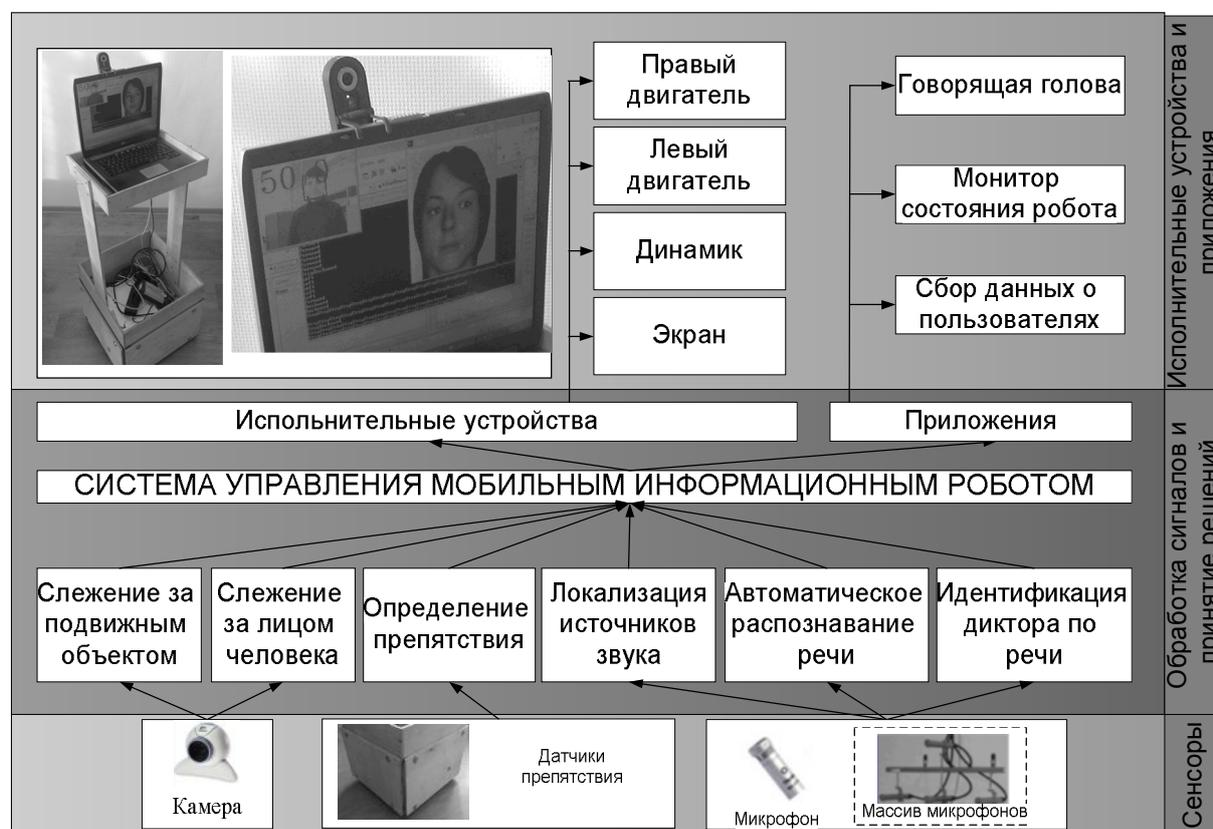
Рис. 1. Технологическая сеть мобильного робота
