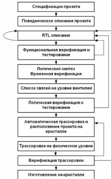
Рис. 1. Традиционный маршрут проектирования ПЛИС/ASIC/SoC на основе HDL -языков проектирования
