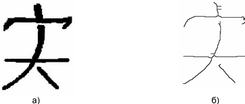
Рис. 7. Результат утончения символа при применении двухэтапного клеточного автомата на базе меток, (а) исходное изображение символа; (б) результирующее изображение символа после работы алгоритма
