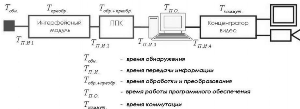
Рис. 2. Задержки в централизованной системе
