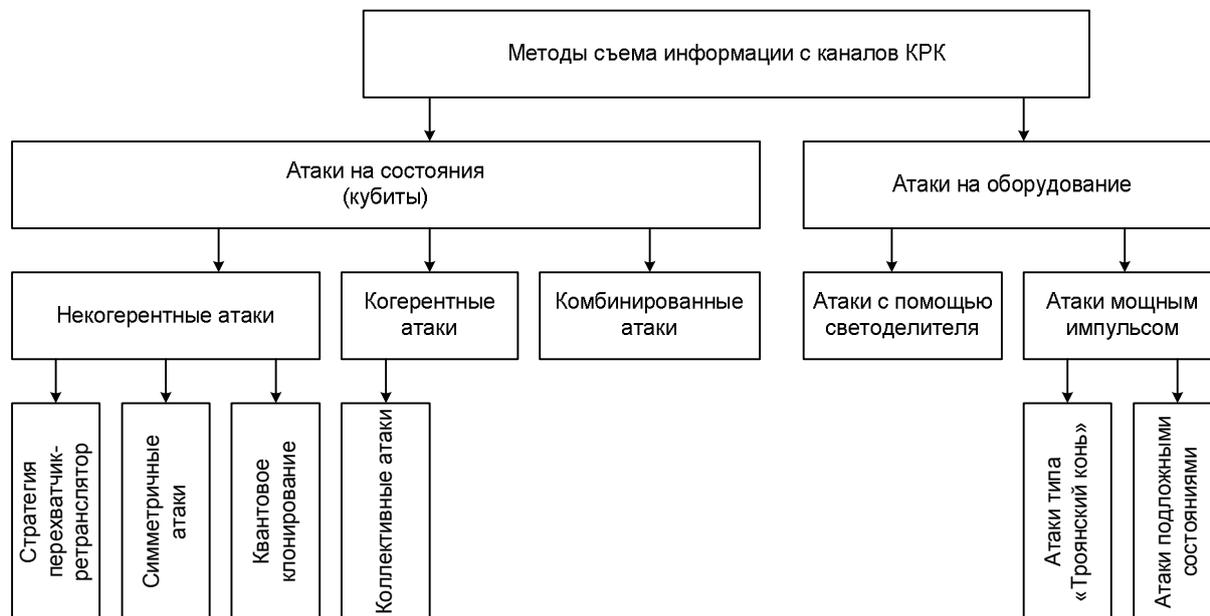
Рис. 1. Классификация атак на каналы квантового распределения ключей
