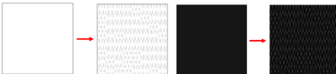
Рис. 2. Визуализация артефактов встраивания при изменении одного коэффициента матрицы ДКП для блоков с разной яркостью
