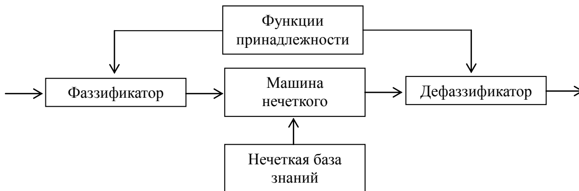
Рис. 2. Схема модели нечеткого контроллера
