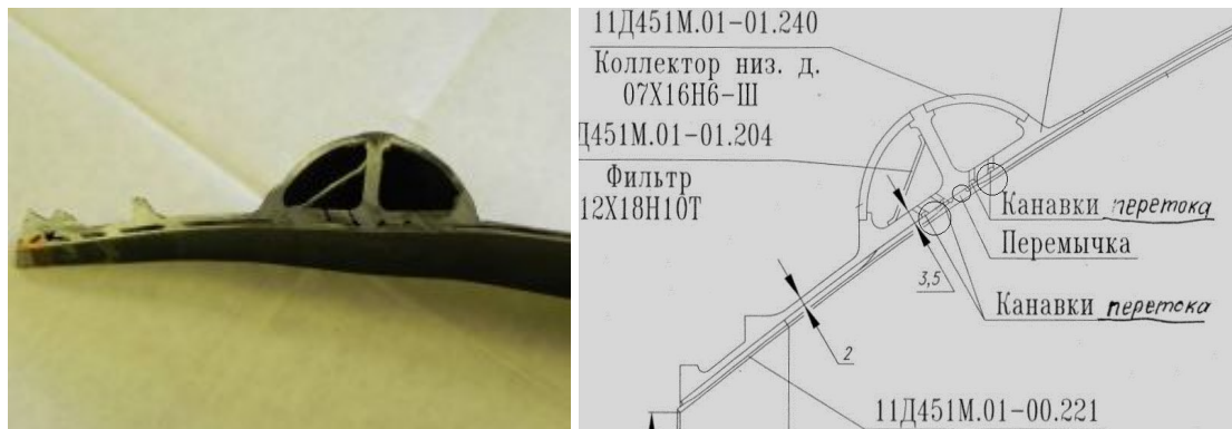
Рис. 2. Вырезка (а) и эскиз подколлекторной зоны (б) сопла камеры ЖРД
