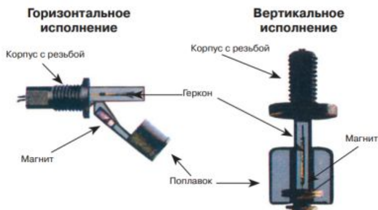
Рисунок. Датчик уровня жидкости поплавкового типа
