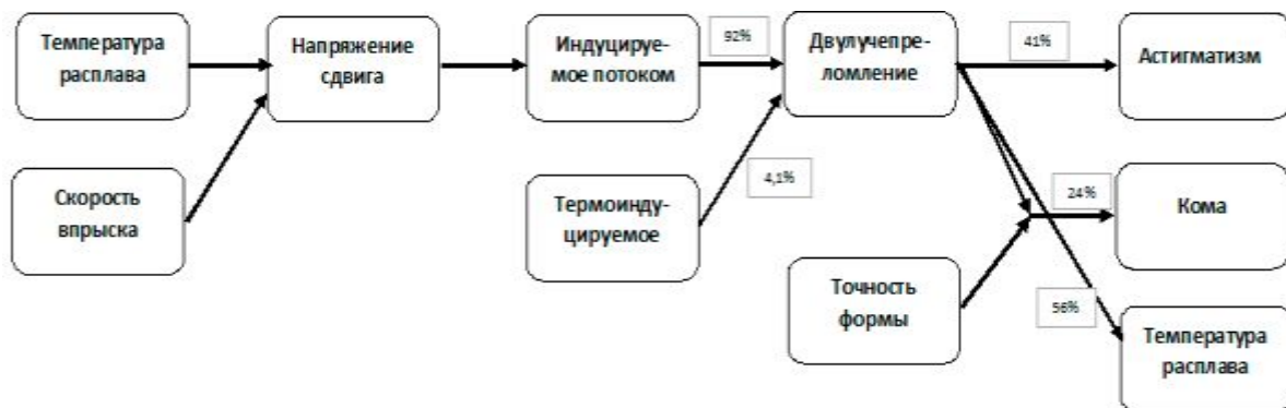
Рисунок. Взаимосвязь между оптическими характеристиками и технологическими параметрами
