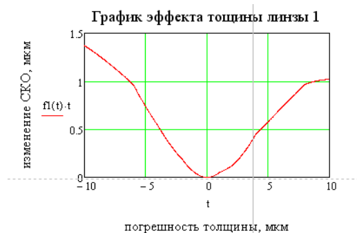
Рис. 6. График влияния изменения толщины линзы на СКО пятна рассеяния
