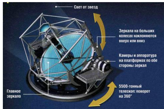
Рис. 2. Конструкция телескопа E-ELT
