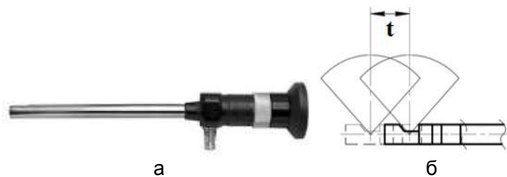
Рисунок. Внешний вид (а) и схема перемещения (б) жесткого зонда бокового обзора
