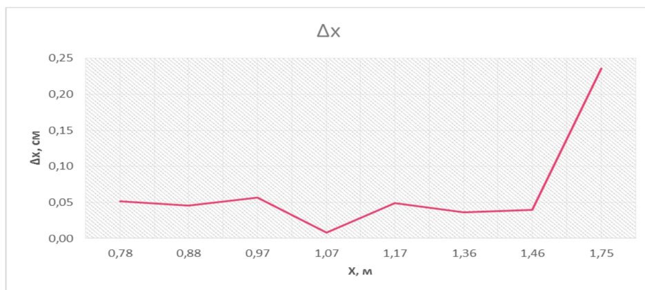
Рис. 1. Зависимость погрешности \Delta X от расстояния до объекта наблюдения
