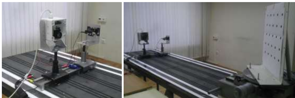
Рис. 2. Экспериментальный образец и испытательно-калибровочный стенд ОЭС
