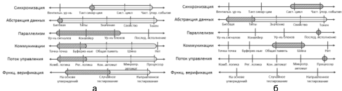
Рис. 2. Механизмы языков: SystemVerilog (синтезируемое подмножество + верификация) (а) и абстрактный ассемблер (б)
