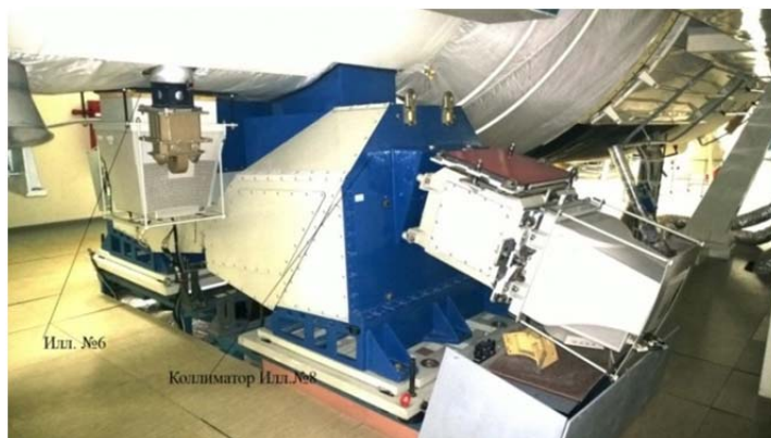
Рис. 1. Оптико-электронная система бокового коллиматора для имитации внешней обстановки в иллюминаторе тренажера МКС
