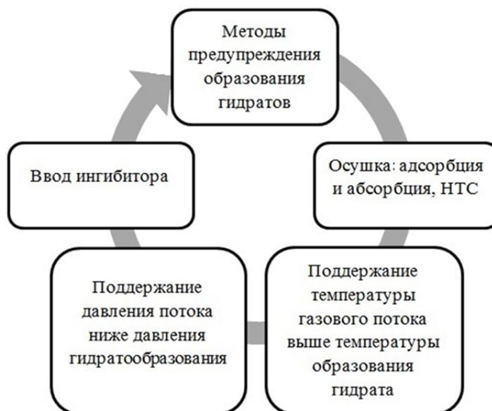
Рисунок. Схема методов предупреждения гидратообразования
