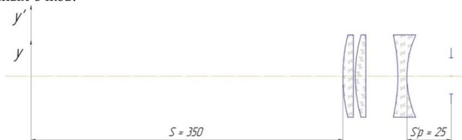
Рис. 4. Оптическая схема рассчитанных операционных очков с увеличением  $\beta = 2,5^\times$ , передним отрезком  $S = 350$  мм и положением выходного зрачка  $S_p' = 25$  мм
