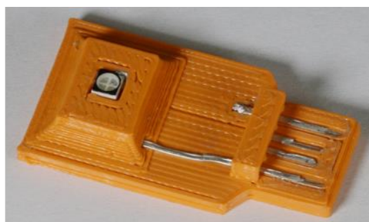
Рис. 2. Совмещенная печать корпуса и проводников с помощью пластика и токопроводящей пасты [4]
