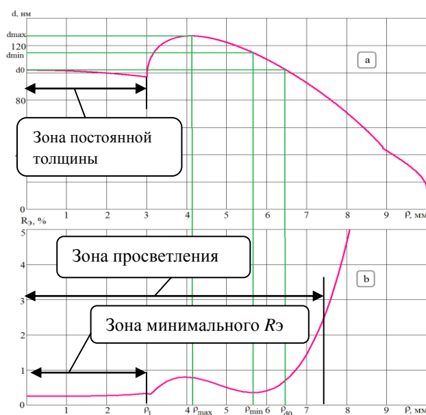
Рис. 4. Распределение энергетического коэффициента отражения в зависимости от изменения геометрической толщины на выпуклой поверхности оптической детали
