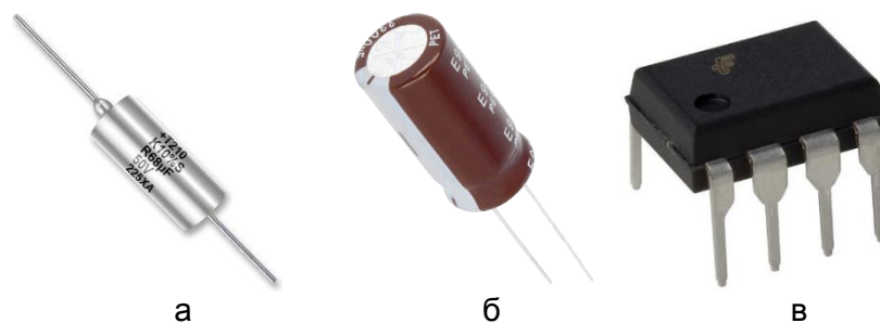
Рисунок. Пример компонентов: конденсаторы с осевыми (а) и радиальными выводами (б); микросхема в корпусе DIP-8 (в)
