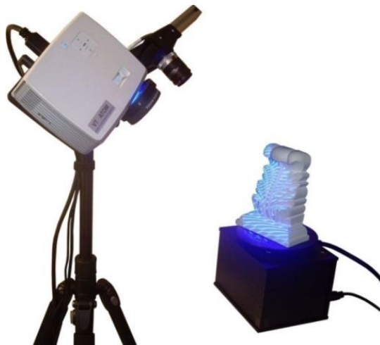
Рис. 2. Пример применения активного бесконтактного метода сканирования
