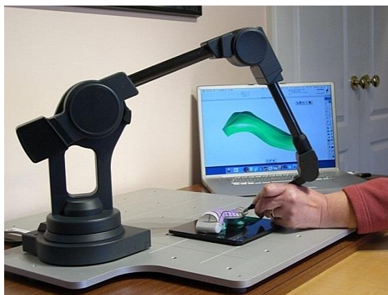
Рис. 1. Пример применения контактного метода сканирования
