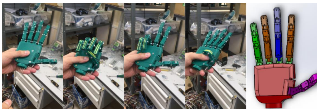
Рис. 6. Изготовленный и собранный макет ладони и 3D-модель ладони в SolidWorks
