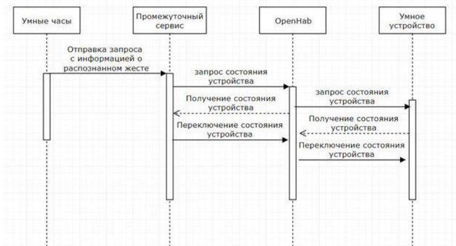
Рис. 5. Схема взаимодействия между умными часами и другим умным устройством
