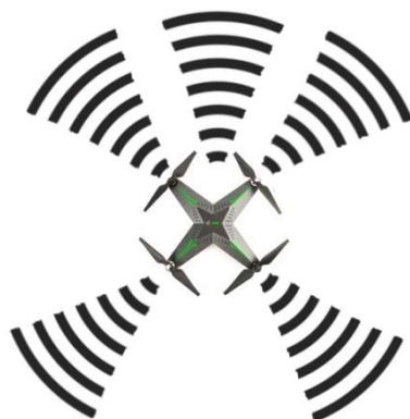
Рис. 2. Расположения дальномеров на квадрокоптере
