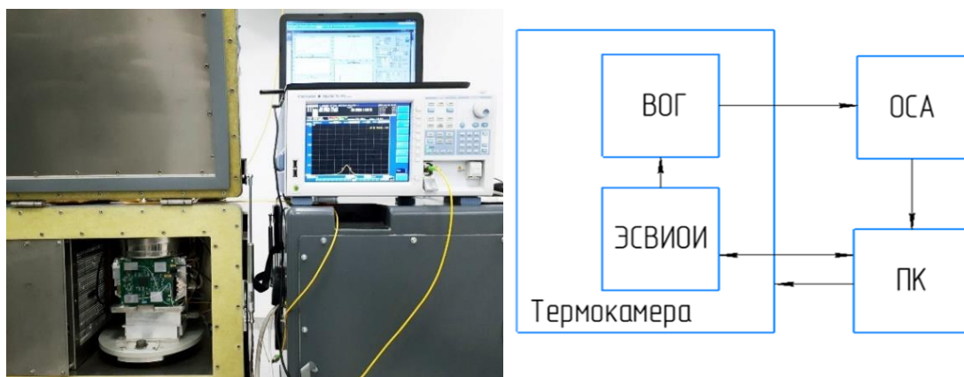
Рис. 1. Фото испытательного стенда для измерения температурной зависимости МК ВОГ
