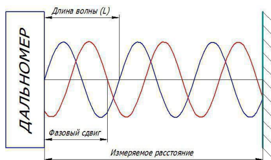
Рис. 1. Принцип действия фазового дальномера
