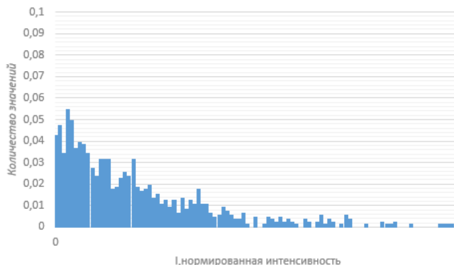
Рис. 3. Гистограмма значений интенсивности спекл-поля для динамических спеклов
