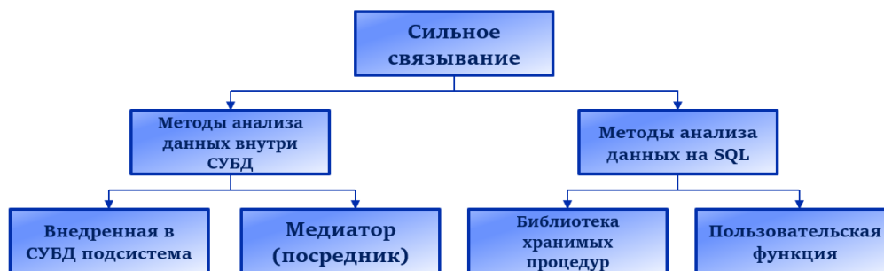
Рис. 2. Способы реализации подхода «сильного связывания»
