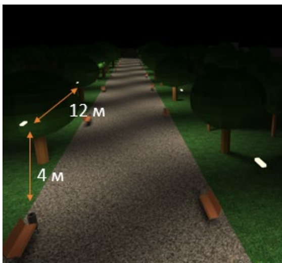
Рис. 1. Модель Poker LED в программе DIALux evo
