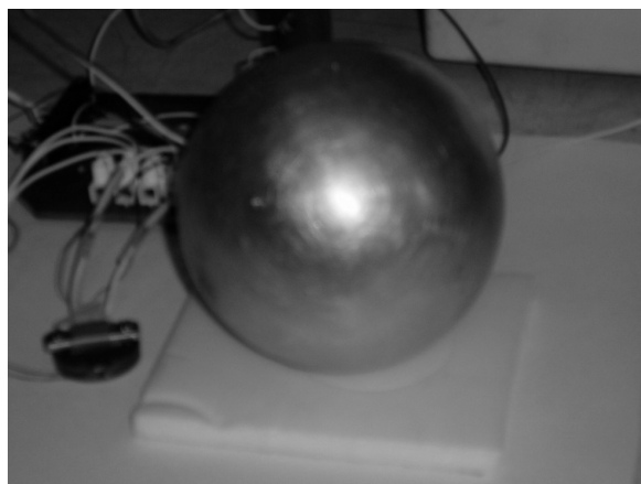
Рис. 3. Сферическая оболочка, предназначенная для стабилизации среды
