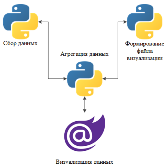
Рис. 2. Структурная схема системы сбора и визуализации потоковых данных
