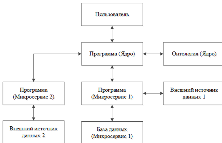
Рис. 1. Функциональная схема системы агрегации данных из открытых источников
