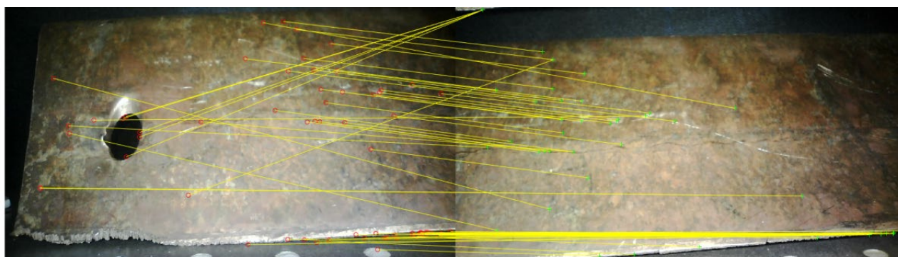
Рис. 4. Сопоставление опорных точек без дополнительной фильтрации
