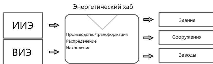
Рис. 2. Устройство энергетических хабов: ИИЭ - ископаемые источники энергии, ВИЭ – возобновляемые источники энергии
