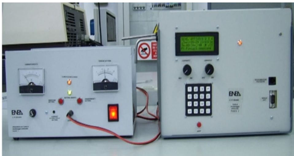
Рис. 2. Переносная газовая сенсорная система для полевых испытаний с автономным блоком питания
