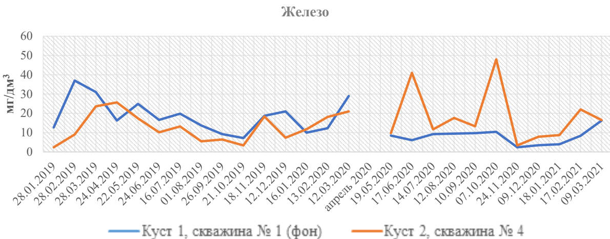
Рис. 3. Содержание железа в точках контроля грунтовых вод
