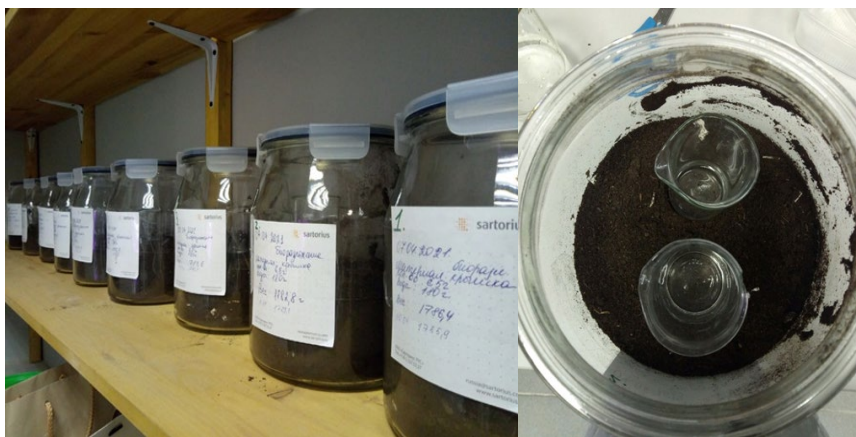
Рис. 3. Емкости с субстратом и ловушкой углекислого газа
