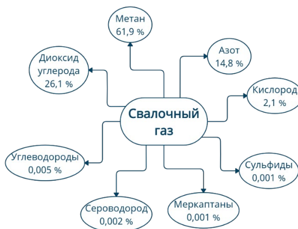
Рисунок. Состав свалочного газа на полигоне «Новый Свет-ЭКО»
