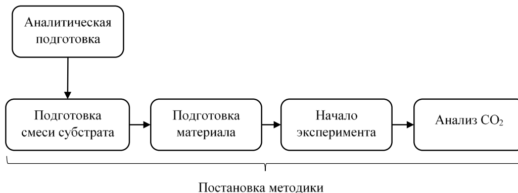
Рис. 1. Схема стадий проведения эксперимента по оценке биоразложения
