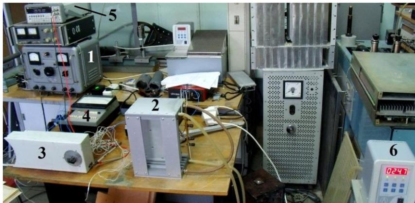
Рис. 4 Прибор установлен в первое положение (тепловые трубы расположены вертикально, зона испарения расположена ниже зоны конденсации): 1 – источник постоянного тока ВСА111Б; 2 – испытуемый прибор; 3 – устройство для измерения температуры ТФП-09; 4 – ампервольтметр Ц4311; 5 – вольтметр В7-78/1; 6 – термостат LOIP LT-100
